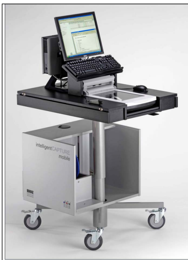
Abbildung 3: intelligentCAPTURE mobile wird direkt zwischen engen Regalen eingesetzt. Der Scanner fährt zum Buch, die hohen Medientransportkosten werden stark minimiert. Über WLAN kommuniziert die Scanstation mit dem Bibliothekssystem, dandelon.com, dem Domino-Server und dem Internet. Die Mitarbeiter kommunizieren über Chat, IP-Telefonie, Application Sharing und eMail mit der Projektleitung. Vom Einsatz gibt es ein Video auf der AGI-Homepage.
